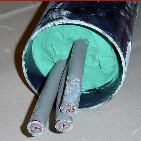
Composé scellant, à un seul composant, plastique, e permanence légèrement expansif (+ 10% en volume au contact avec de l'eau), pour imperméabiliser des trous souterrains, à travers lesquels passent un ou plusieurs câbles et/ou des tuyaux techniques, dans les structures de construction. Il est extrudé autour des câbles passants au moyen d'un pistolet de dosage spécifique pour sacs de 600 ml, puis recouvert avec du mortier thixotrope Repair Tix G2.
