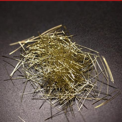
Micro-fibres en acier laitonné, obtenues de la coupe de fil métallique pour le renfort structurel d'agglomérats cimentaires en général. Readymesh MR se présente comme de très fins fils d'acier laitonné de 0,22 mm de diamètre et de 6 o 20 mm de longueur, utilisés principalement pour renforcer le béton et les mortiers à hautes prestations. Readymesh MR sont disponibles en deux longueurs différentes : Readymesh MR-060 = 6 mm ; Readymesh MR-200 = 20 mm
