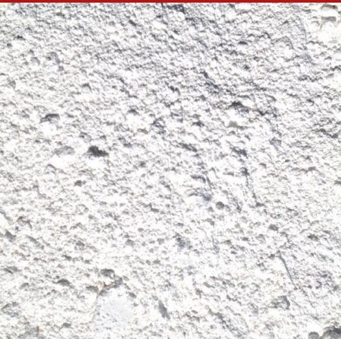
Chaux hydraulique naturelle, de couleur blanc, obtenue à travers la culture, en fours verticaux de pierres et briques réfractaires, à des températures inférieures à 1100°C., de calcaires marneux sélectionnés, de qualité constante, spécifique pour confectionner mortiers, enduits, chapes de fondation dans des constructions écologiques et dans des interventions de restauration historiques et monumentales.
